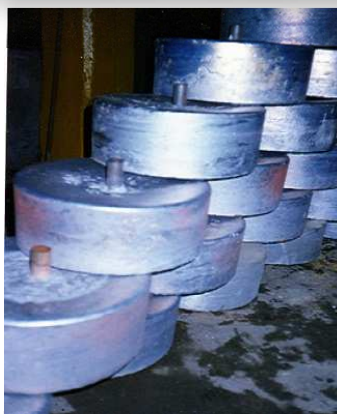
ÂNODOS TRONCOCONICO P/PROTEÇÃO DE TANQUE DE PETRÓLEO
