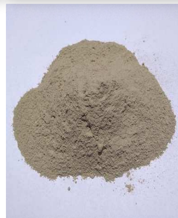
BACKFILL / MISTURA DESPOLARIZANTE
