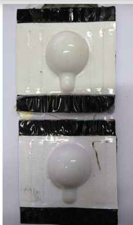
PARCHES P/SOLDAGEM CUPROALUMINOTERMICA
